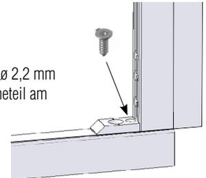
Die Fahne der Montagerahmenprofile, oben mittig und seitlich nach den angegebenen Maßen, mit Bohrer  $\varnothing 4,0$  mm von vorne durchbohren. In der Höhe mind. 4 Bohrungen. Anschließend mit dem Kegelsenker  $\varnothing 8$  mm ansenken. Von hinten die Bohrungen entgraten.
