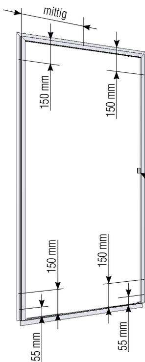
Befestigungsschrauben am Winkelprofil leicht hemmend lösen. Montagerahmen vor dem Blendrahmen positionieren und Winkelprofil zum Blendrahmen (Trittblech) anpassen. Befestigungsschrauben wieder anziehen.
