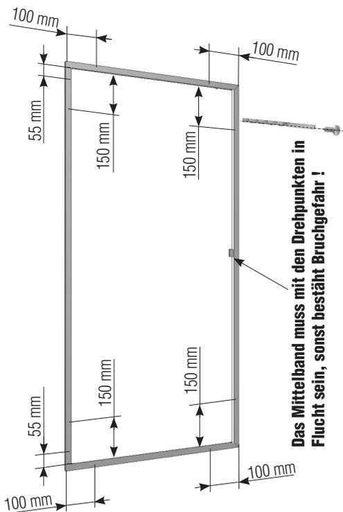
Montagerahmen oben und seitlich mit Bohrer  $\varnothing 4,0$  mm nach den angegebenen Maßen (**Achtung: Blockmagnet in Rahmenprofil!**) von vorne durchbohren und mit dem Kegelsenker  $\varnothing 9,8$  mm 17 02 10.09 die erste Profilwand durchsenken. In der Höhe mind. 4 Bohrungen. Breitenabhängig eventuell zusätzliche Bohrung mittig in den waagerechten Profilen.
